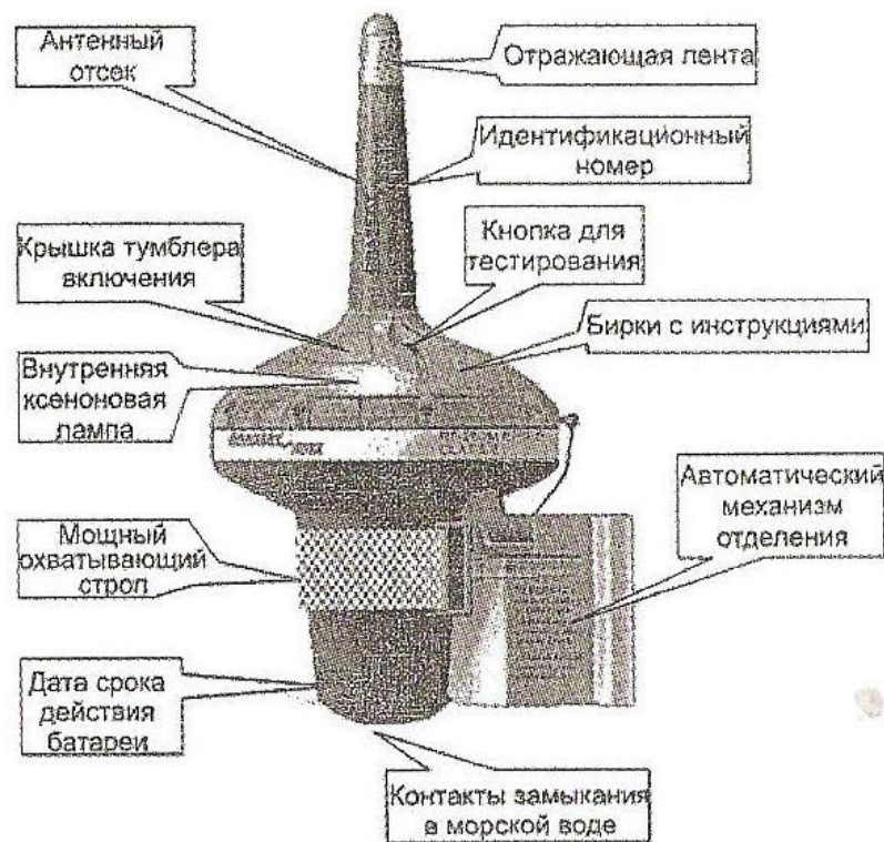
Рисунок 1 - Устройство АРБ-406 типа 260RT с механизмом крепления.
